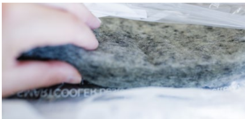
Das Herz des Smartcoolers besteht aus einem Isoliervlies auf Recyclingbasis.
