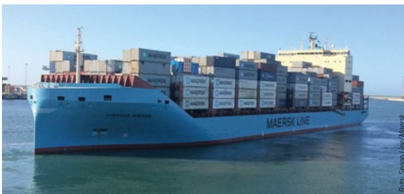
Alle Maersk-eigenen Schiffe wurden mit der für RCM nötigen Netztechnik versehen. Hier im Bild die Vistula Maersk, das erste Schiff einer Reihe, die laut Maersk die weltweit größten Containerschiffe der Ice Class sind. Diese Short Sea Schiffe werden auf der Nord- und Ostsee eingesetzt und haben eine speziell verstärkte Hülle, für Fahrten bei bis zu -25 °C. Außerdem verfügen Vistula Maersk und ihre Schwestern über eine extra große Anzahl von 600 Reefer-Anschlüssen bei einer Gesamtkapazität von 3596 TEU.
