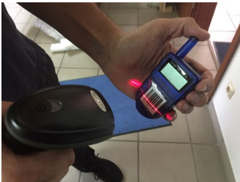
Beim neuen »Service-Lotsen« erfolgt die Auftragsannahme durch das Scannen des am Pager angebrachten Barcodes am Einsatzort.
