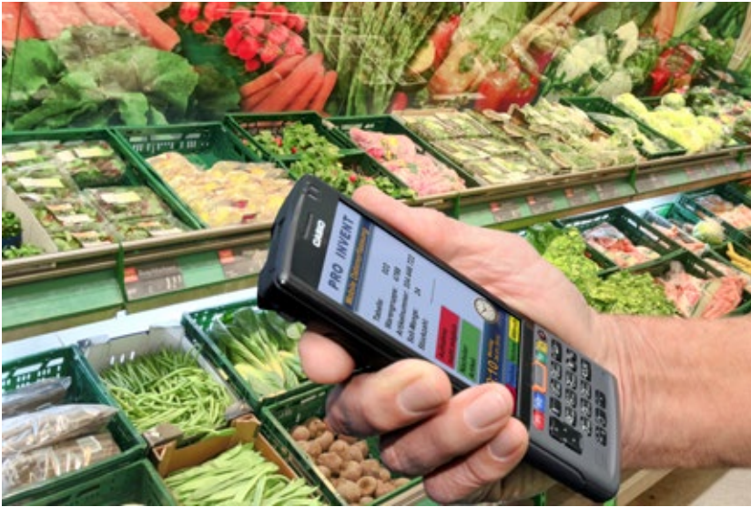
Die ergonomisch angeordneten Scanner- und Eingabetasten des Casio IT-G500 fördern die Einhandbedienung und der abgewinkelte Scannerkopf soll Verkrampfungen und Ermüdungen der Hand verhindern.
