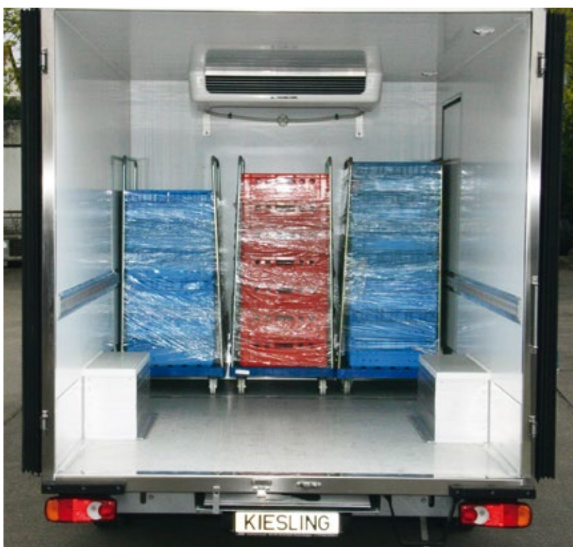
Der Runner in der Variante mit Platz für bis zu elf Rollcontainer.
