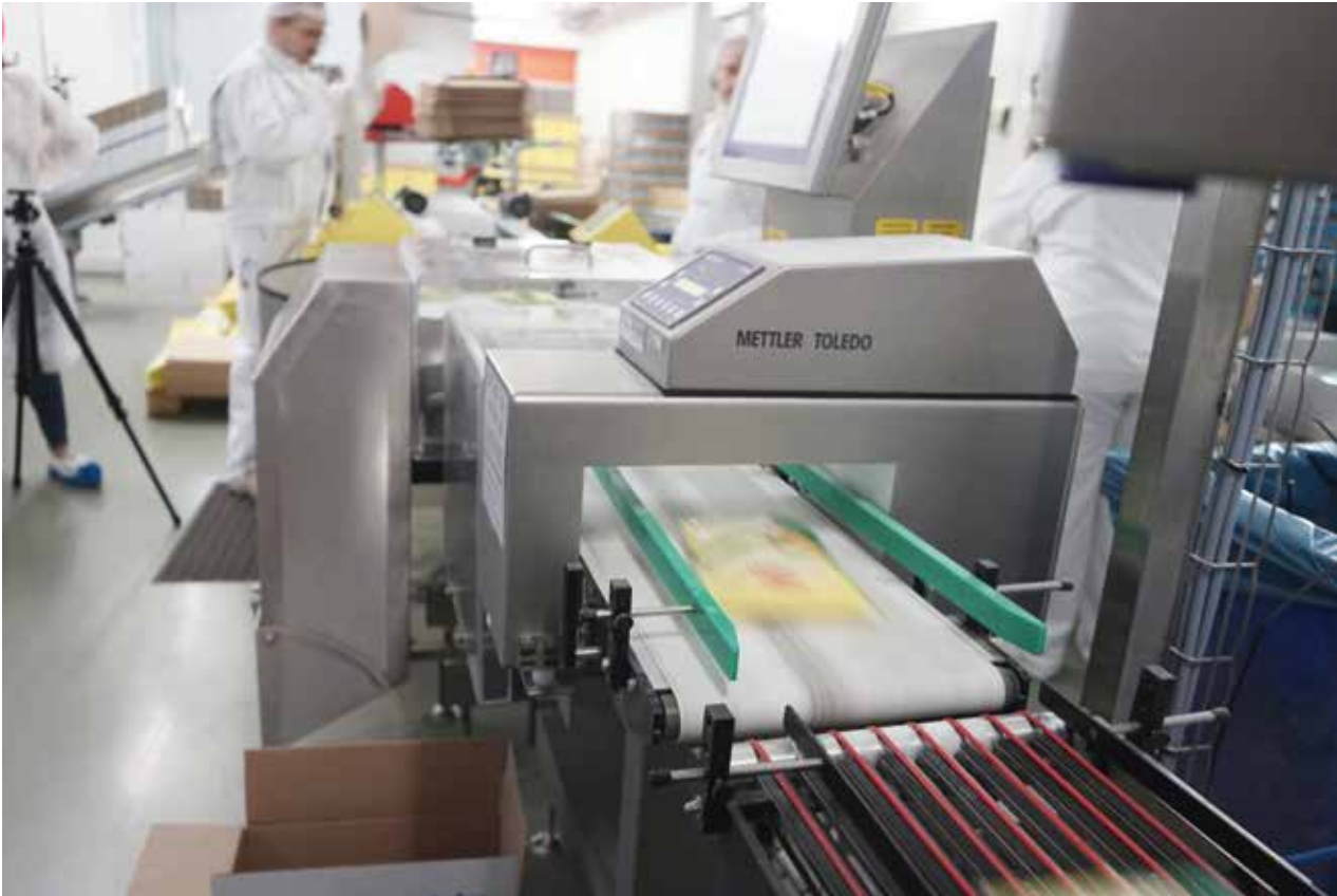
Die Kombigeräte, bestehend aus einer Kontrollwaage und einem Metallsuchgerät, sind als kritische Kontrollpunkte jeweils am Ende der Verpackungslinie hinter Tiefzieh- und Schlauchbeutelmaschinen installiert.
