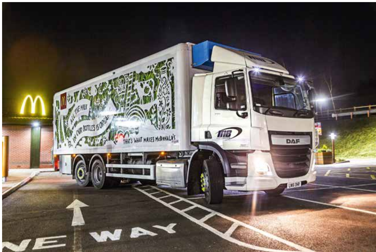
Die LKW von Martin Brower UK fahren ausschließlich mit Biodiesel aus gebrauchtem Speiseöl, das vom Kunden McDonald's eingesammelt und dann aufbereitet wird.
