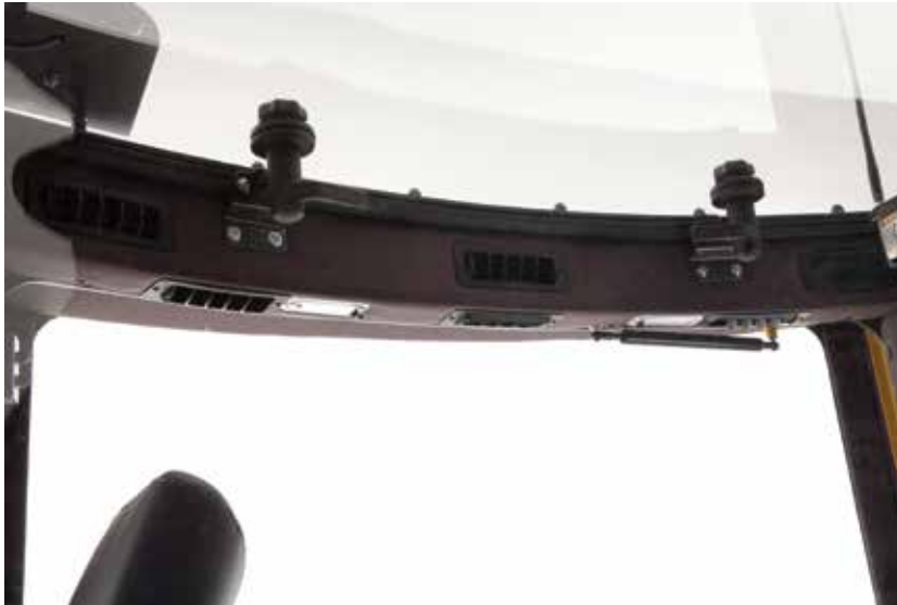
Dachfenster mit Notausstieg beim Tergo UMS.
