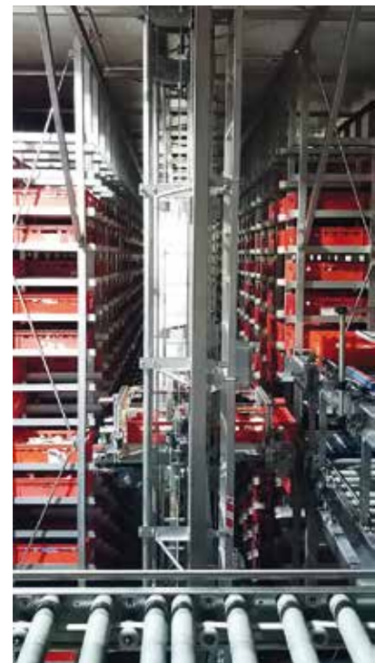
Drei Regalbediengeräten der Marke Neo.VA sind bei Heidemark im Einsatz.
