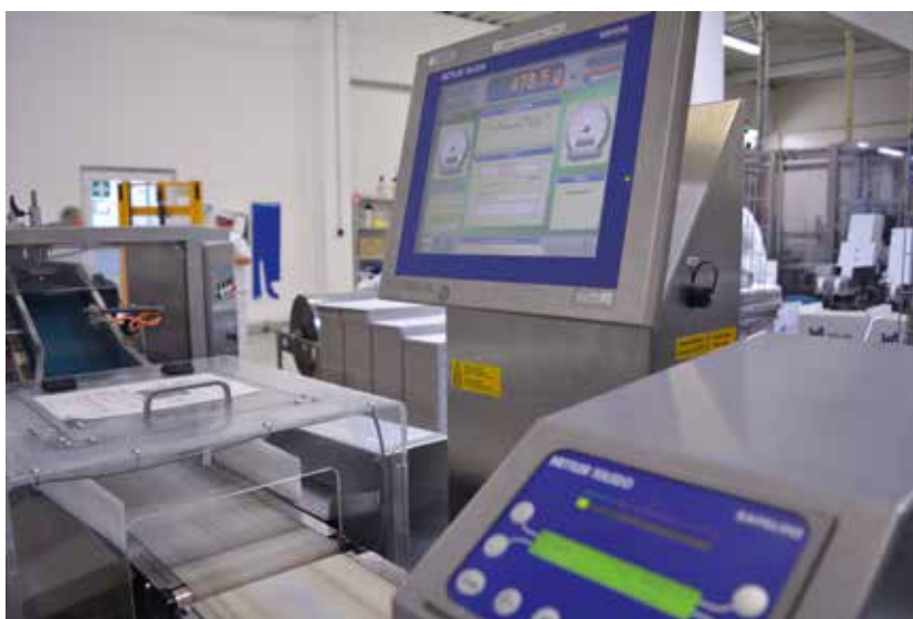
Mit der Installation von fünf Kombigeräten und einer Inspektions- und Datenmanagement-Software von Mettler-Toledo vermeidet die Heinrichsthaler Milchwerke GmbH Produktverunreinigungen sowie Über- und Unterfüllungen.
