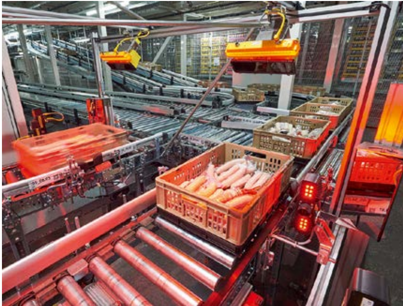
Über ein Kamera-Scan-System im Wareneingang wird der Inhalt der Behälter exakt verifiziert und dokumentiert.
