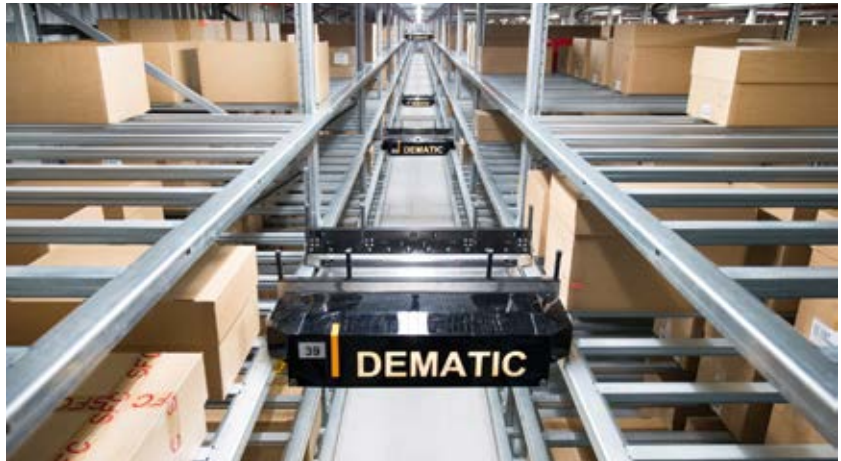
Die italienische Polo SpA stattet ihr Kühl- und Tiefkühlager in Telo mit zwei Multishuttle-Anlagen aus, um die Lebensmittel automatisiert zu kommissionieren.
