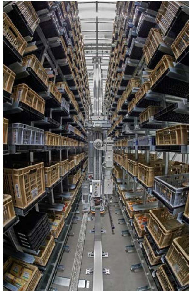
Dynamische Behälterbereitstellung durch Regalbediengeräte in den temperaturgeführten Logistikbereichen.
