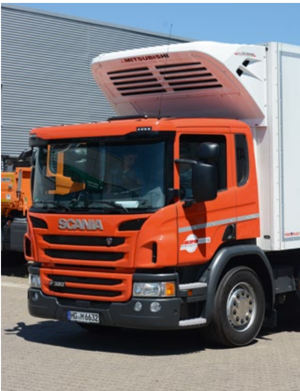
Die am Scania Hybrid-LKW montierte Transportkältemaschine von Mitsubishi wird voll elektrisch betrieben – das spart weitere Emissionen.
