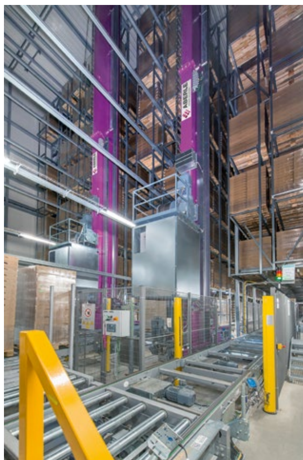
RBG mit doppeltiefem Lastaufnahmemittel und zwei Antrieben kommen im neuen HRL zum Einsatz.
