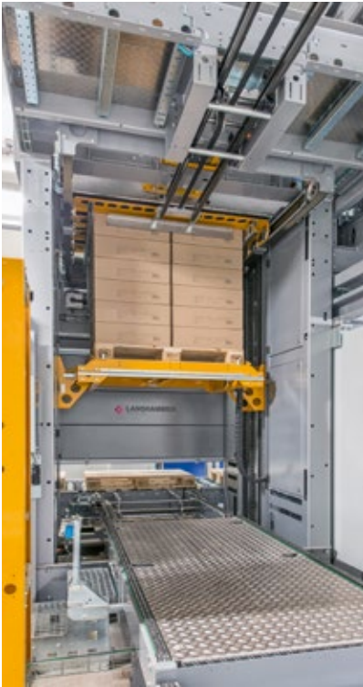
Ein Lagenpalettierer PA 8 mit Palettenhubwerk sorgt für schnelle Palettierung der TK-Produkte.
