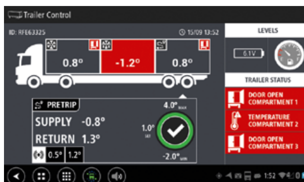
Dank der Kooperation von Astrata und Krone sieht der Fahrer auch den Status der Türen in den Kühlzonen.
