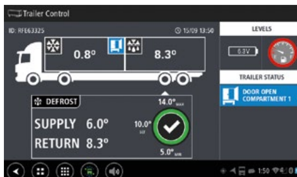
Der Fahrer sieht im Fahrerhaus auf dem Display, wie kalt die Kühlzonen seines Trailers Cool Liner Multitemp aktuell sind.
