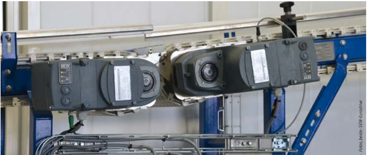
Die Kunststoff-Kettenförderbänder bei Lofotprodukt werden durch das mechatronische Antriebssystem Movigear von SEW-Eurodrive angetrieben und gesteuert.
