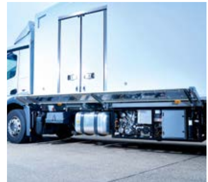
Von einem Dearman-Motor angetriebenes Kühlaggregat.
