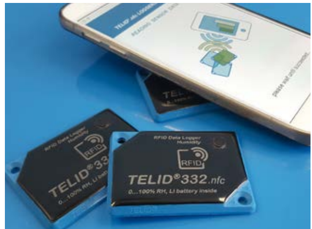
Haben das Format einer halben Chipkarte: Datenlogger der Telid 3X2 Produktreihe.
