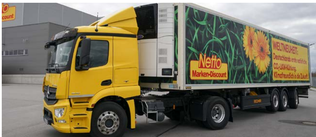
Seit mehreren Monaten ist das dank geschlossenem CO 2 -Kühlsystem nachhaltige Testaggregat von Carrier Transicold mit Netto Marken-Discount in Bayern unterwegs.
