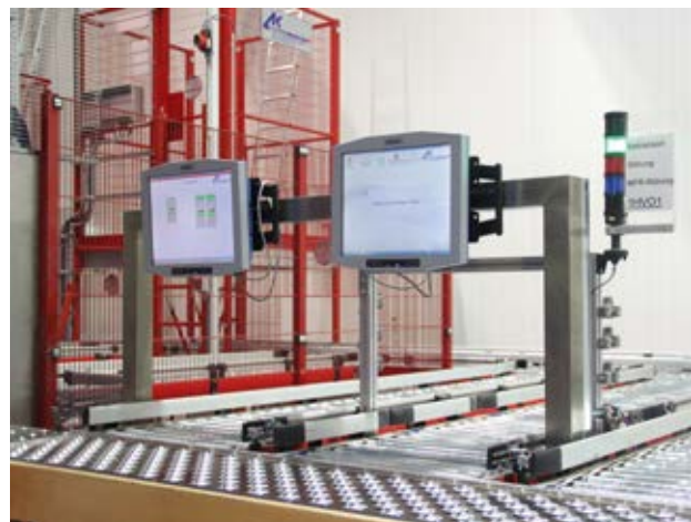
Fördertechnik Vorzone mit Kommissionierarbeitsplatz.
