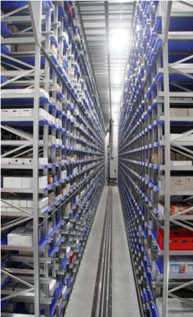
Das Tiefkühlager bietet 9120 Tablar-Stellplätze.
