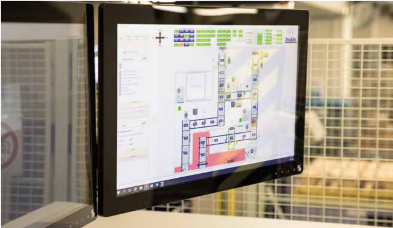
Die Steuerung des Materialflusses, inklusive dessen tagesaktuell bedarfsgerechte und kontinuierliche Optimierung, obliegt dem StöcklinWCS.
