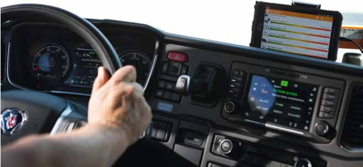
Das fahrende Personal ist immer aktuell informiert: Über das androidbasierte Telematiksystem kann der Transportdienstleister relevante Dokumente ohne großen Aufwand zeitgleich in alle Fahrzeuge verteilen.
