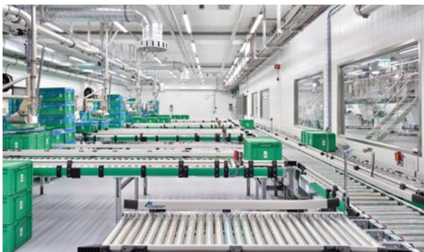
Die komplexen Prozessen wie Beschicken der Mischerei mit verschiedenen Rohstoffen und vorgemischten Chargen, das Verwiegen und Abfüllen in Edelstahl-Container, das Rückführen der Rohstoffe ins Lager sowie das Leergutmanagement müssen auch in der IT-Landschaft aufeinander abgestimmt sein.
