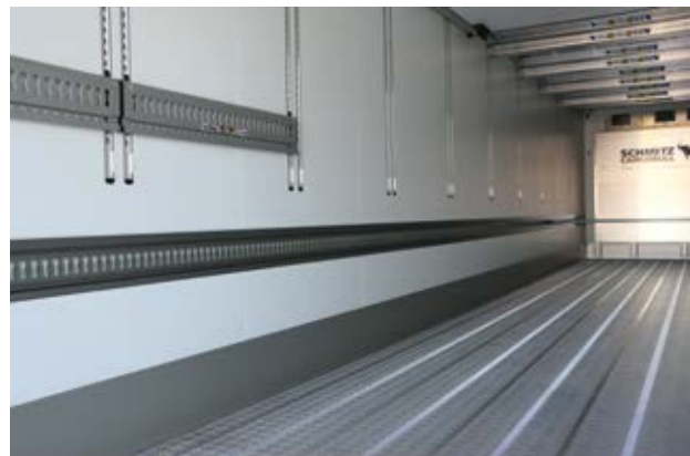
Der Multifunktionsboden hat eine neue Oberfläche, die laut Schmitz rutschfest und eisfrei ist und so den Personal-Ausfall durch Unfälle vermeiden hilft.
