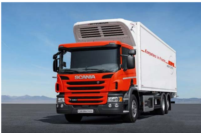
LKW von Meyer Logistik mit Mitsubishi TEJ 100 Kühlaggregat.
