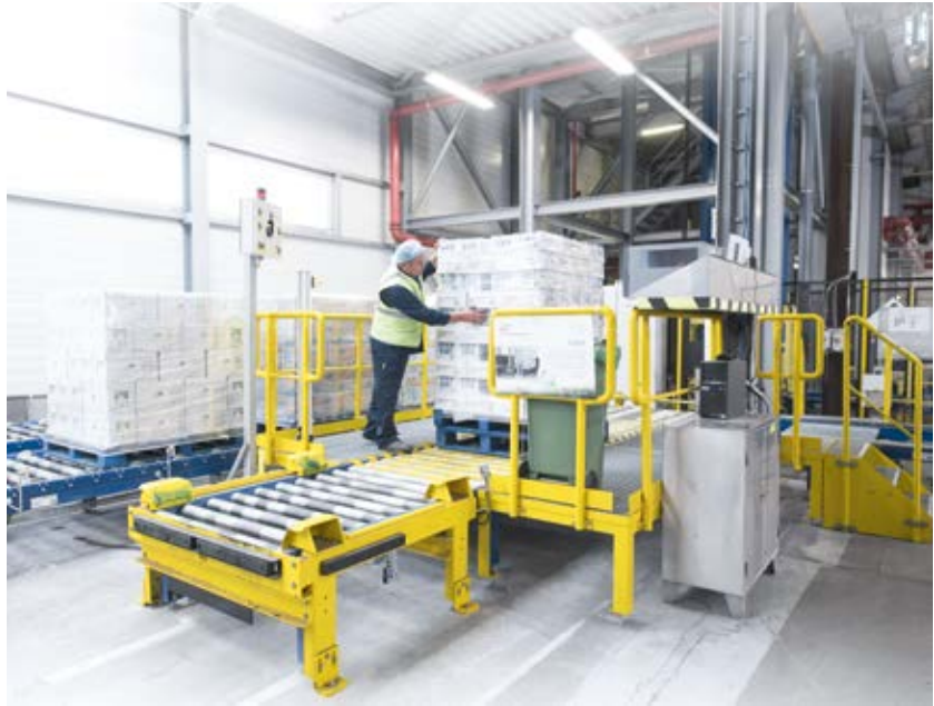
An dem von SSI Schäfer zusätzlich eingerichteten I-Punkt werden Gewicht und Abmessungen der etikettierten Paletten erfasst.
