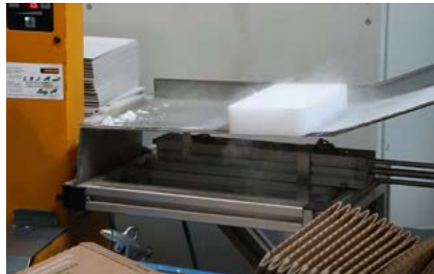
Die Box wird über Trockeneisscheiben gekühlt.
