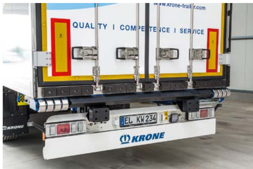
Am Heckportal schützen beidseitig vier Roll-Compression Buffer das Fahrzeug.
