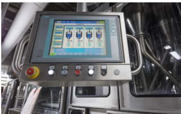
Das Scada System ist offen für verschiedene Endgeräte, visualisiert alle Prozesse und erleichtert damit deren Kontrolle und Optimierung.
