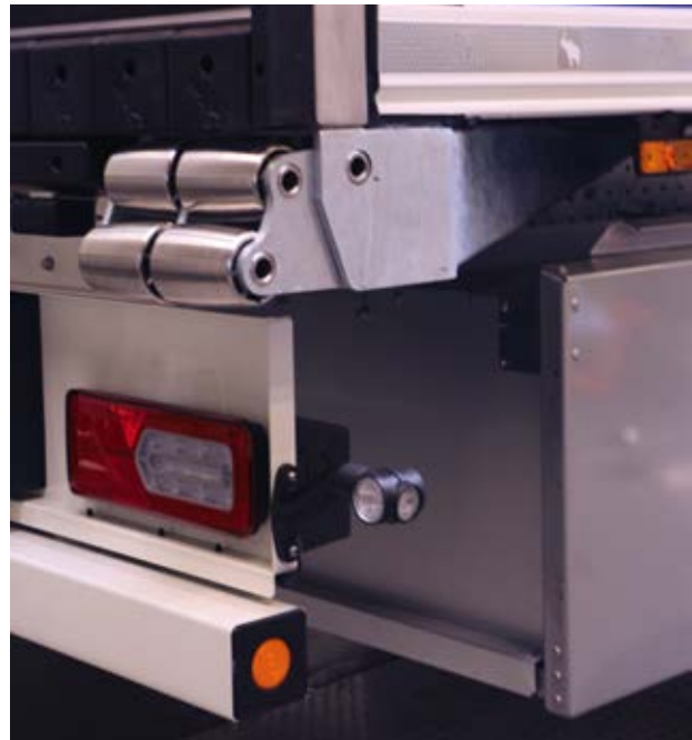
Die Dynamic Ramp Protection absorbiert Anfahrerenergie.
