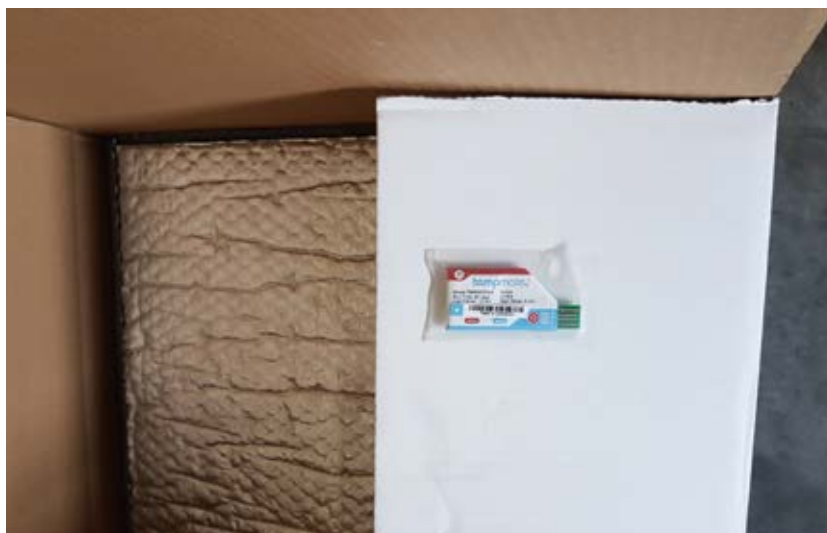
Pharmabox mit Isolierung und Logger für Umgebungstemperatur.
