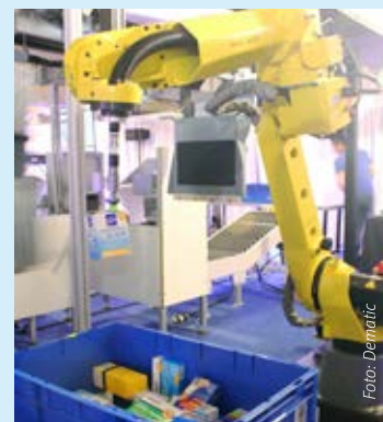
Der australische Lebensmittelhändler Drakes Supermarkets automatisiert mit dem Roboter Piece Pick Module von Dematic seine Kommissionierung.
