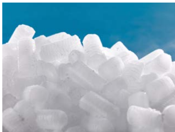
Trockeneis-Pellets sind eine der möglichen Einsatzformen des festen CO 2 .
