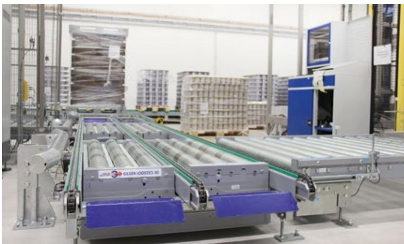
Die Anbindung der durch Hochdorf realisierten Dosenlinie 2 mit Anschluss an einen automatischen Lagenpalettierer wurde mit der Palettenfördertechnik erschlossen. Nach dem Stretchen, der Etikettierung und der Profilkontrolle der Paletten werden sie ins Hochregallager transportiert.
