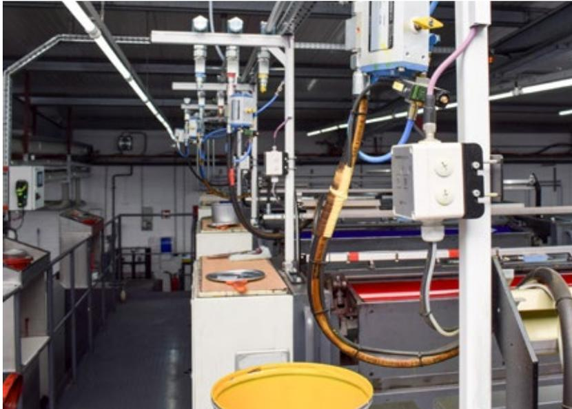
*Volumetrische Mengemessköpfe, die unmittelbar in der Rohrleitung vor der Druckmaschine eingebaut sind, erfassen den Farbfluss jeder Farbe.*
