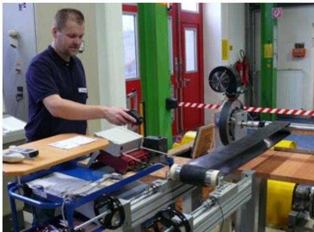
*Auf dem hauseigenen Prüfstand für Trommelmotoren testet Rulmeca die individuelle Auslegung von Trommelmotoren auf Herz und Nieren. Für sensible Anwendungsbereiche kann so nach Angaben des Unternehmens das thermische Profil des Motormantels mit dem Wirkungsgrad und den Kosten für den Motor optimal ausbalanciert werden.*
