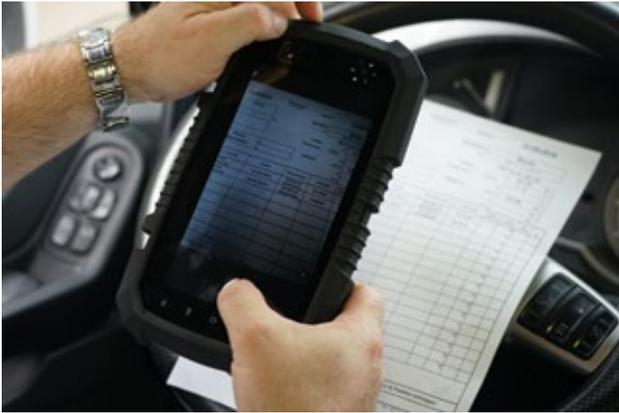
Die »Navtabs« der zweiten Generation verfügen über eine Front- und Rückkamera, mit der zum Beispiel Ablieferbelege fotografiert und anschließend in digitaler Form an die Zentrale gesendet werden können.
