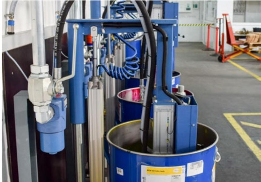
Das System informiert präzise über den Farbverbrauch, wann eine neue Farbcharge in der Rohrleitung an einer Druckmaschine angekommen ist.
