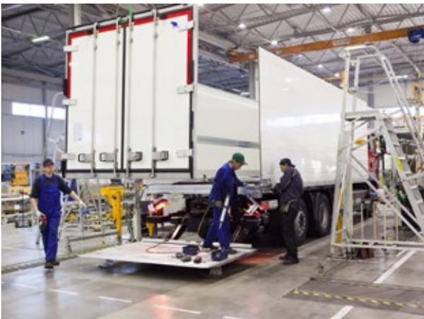
Die Seitenwände für Kühl-Sattelkoffer mit einer Gesamtlänge von 16,80 Meter können vom Schmitz-Werk in Litauen jetzt an einem Stück gefertigt werden.
