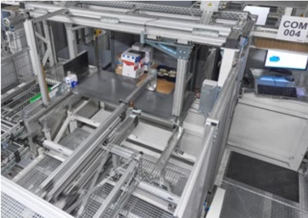
Das Herzstück der Asko-Anlage ist das OPM-System: 14 COMs kommissionieren hier mehr als 7000 Handelseinheiten pro Stunde.
