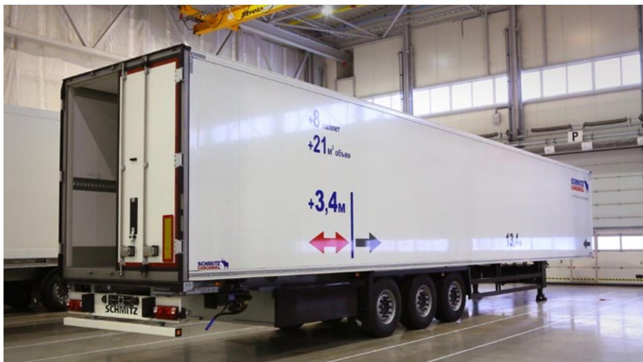
Die 25 Prozent mehr Länge des Lang-S.KO bedeuten 25 Prozent mehr Paletten.
