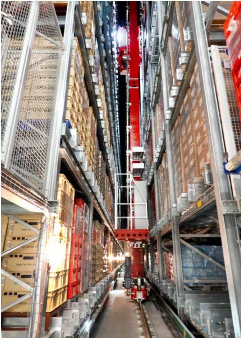
Die Produktlagerung erfolgt im vollautomatischen Hochregallager bei einer Temperatur von circa  $-28^{\circ}\text{C}$ .
