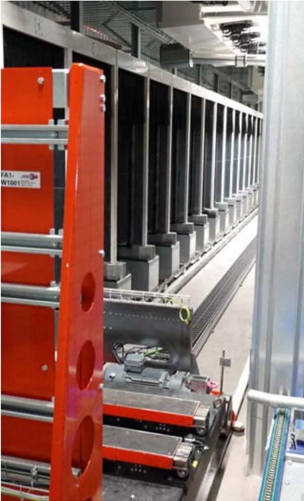
Über das automatische Fördersystem werden die Paletten zur Schockfroster-Anlage gefördert und nach Abschluss des Frostprozesses automatisch im Hochregallager eingelagert.
