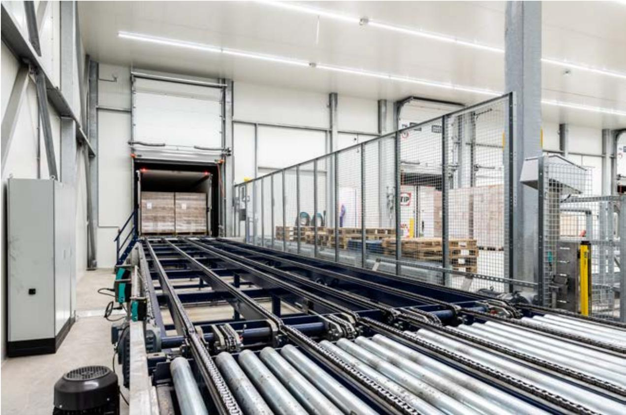
Die Fördertechnik ist an ein automatisches LKW-Beladesystem angebunden, welches die Waren gesammelt in den LKW transportiert.
