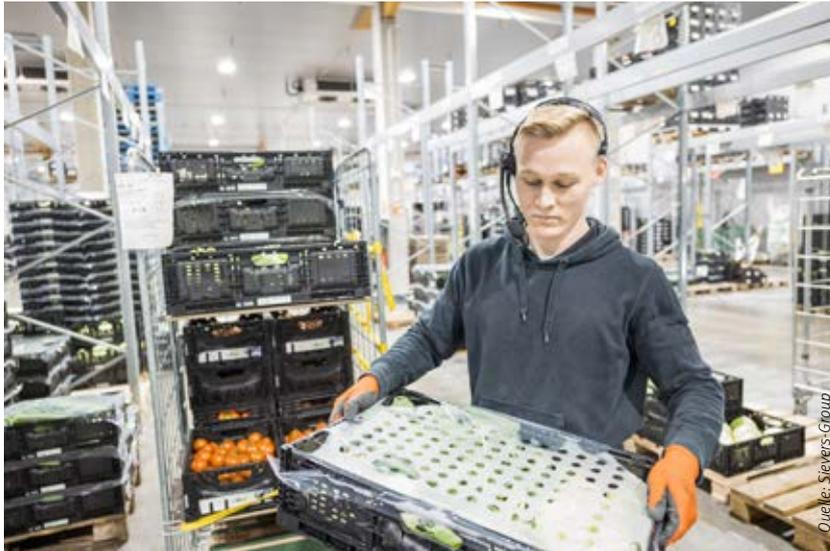
Die Kommissionierung erfolgt mithilfe eines W-Lan-gesteuerten Pick-by-Voice-Systems, das die Mitarbeiter wegeoptimiert durch das Lager führt..
