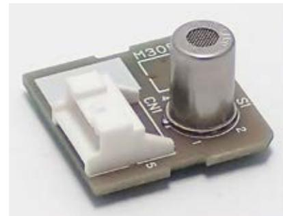
*Der Sensor FCM2630 für leicht entflammbare Kältemittelgase.*
