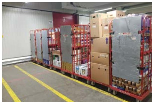
Fertig kommissionierte Rollbehälter mit der Transportsicherung von Roll-Safe.
