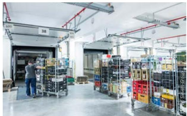
Alle Einzelpositionen einer Bestellung werden in der Verladezone zusammengeführt und mithilfe des LVS auf die richtigen LKW-Verladetore verteilt.
