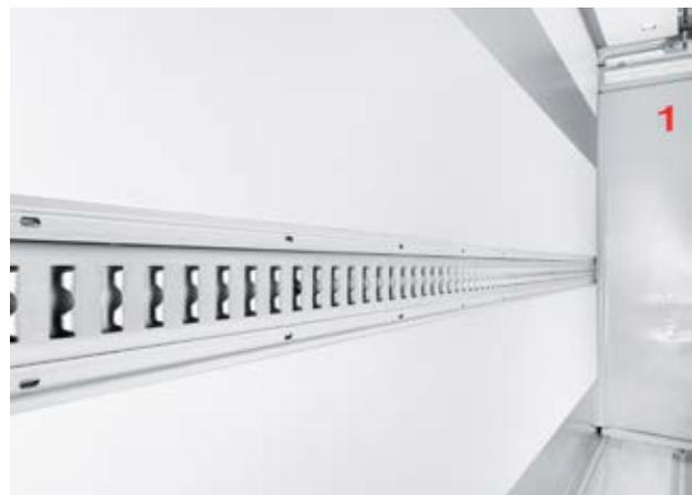
Voll integrierte Paneele sorgen für plane Wände im Kühlkoffer von Kiesling.
