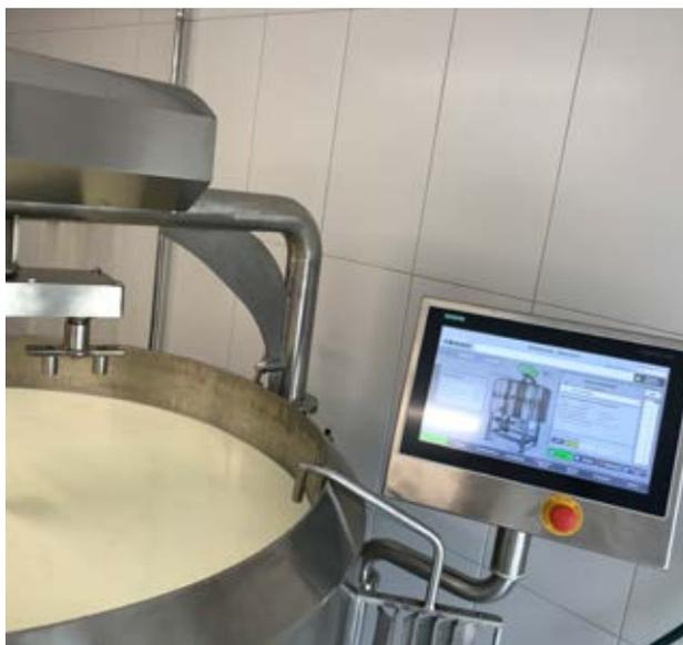
Der mit Siemens-Komponenten automatisierte Käsekessel der Giovanelli GmbH bietet eine integrierte Rezepturverwaltung und ermöglicht den Fernzugriff per PC oder Mobiltelefon.
