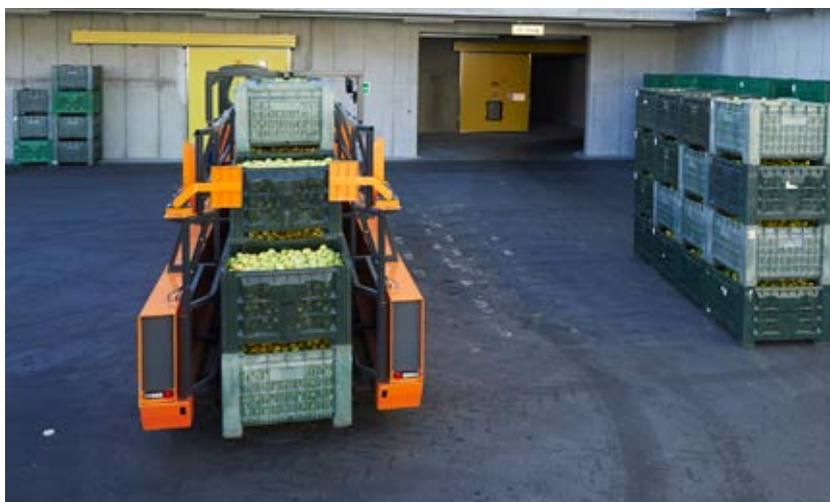
Durch die Abmessungen des Apfelkistentransporters von 10 Metern Länge und 2,40 Metern Breite ist ein Befahren der Nebengänge bis direkt vor die Kühlzellen möglich.
