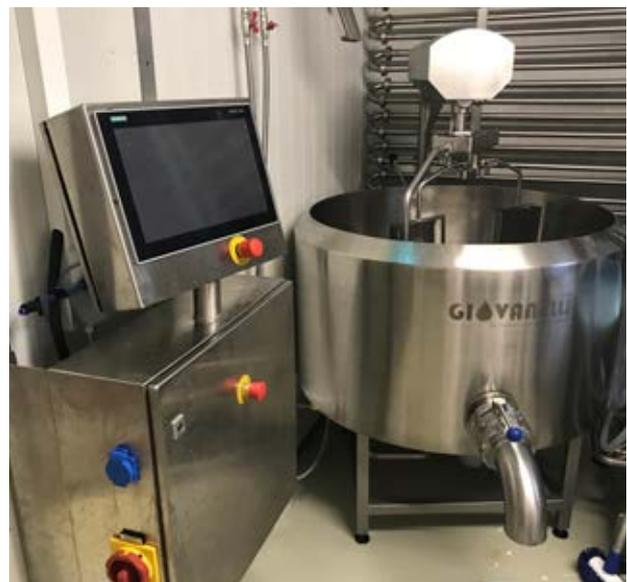
Der Panel-PC Simatic IPC von Siemens eignet sich für eine kostengünstige Realisierung von Human Machine Interface (HMI) Anwendungen.
