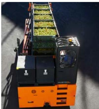
Der Apfelkistentransporter KTR 120 kann bei einer Traglast von zwölf Tonnen sieben Stapel mit jeweils vier Kisten aufnehmen und bis zu 144 Kisten pro Stunde transportieren.
