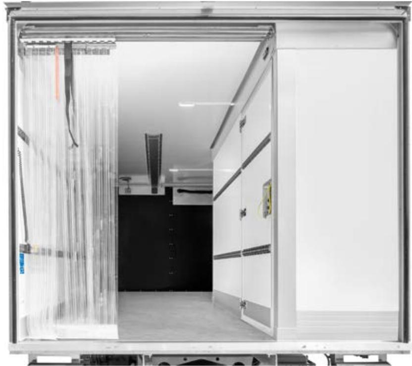
*Im Mercedes-Benz Atego für die Bäckerei Konditorei Wolf ist eine Kühlkammer in einen Trockenfracht-Koffer Flexbox Dry integriert.*
