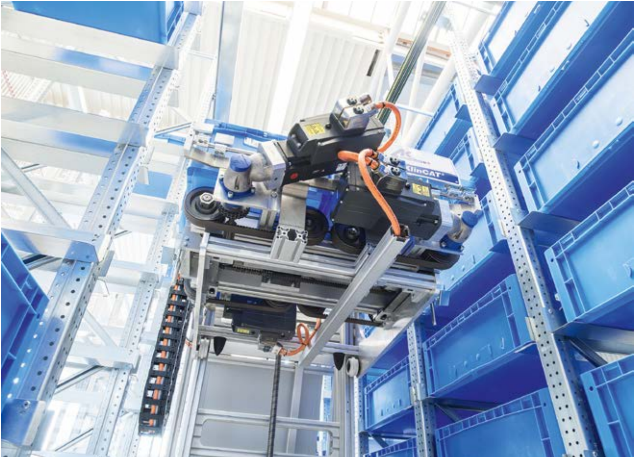
Ein Klinkcat-Multilevel-Shuttlelager ist für Frischwaren vorgesehen.
