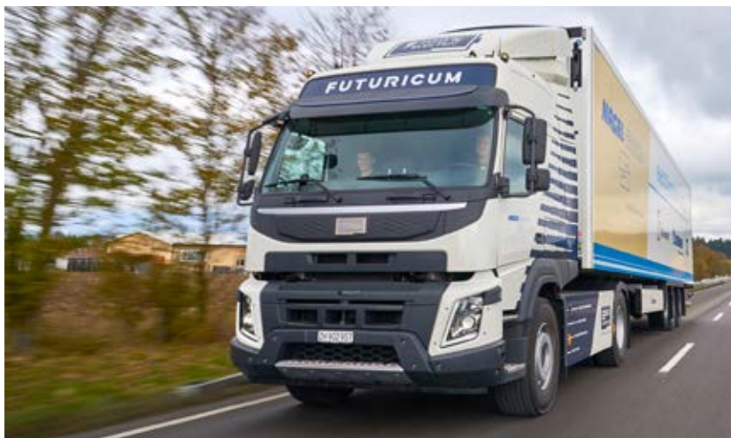
Die vollelektrische Zugmaschine Futuricum Semi 40E wird eine kurze Zeit gemeinsam mit einem elektrischen Kühltrailer von Krone und THT Heetkamp getestet. Der Trailer soll danach noch in anderen Regionen eingesetzt werden.
