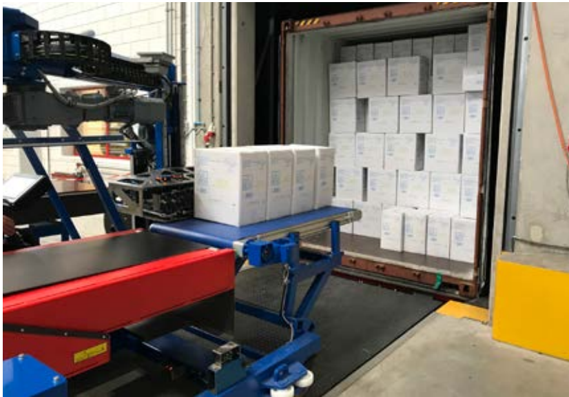
Auch zum Einsatz in Kühllhäusern geeignet: Copals Container-Entladeautomat.
