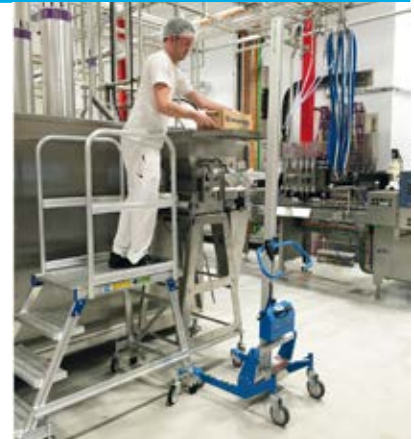
Lift&Drive Hebegerät zur Verwendung speziell in den Sauber- sowie Reinraum Hygienebereichen.
