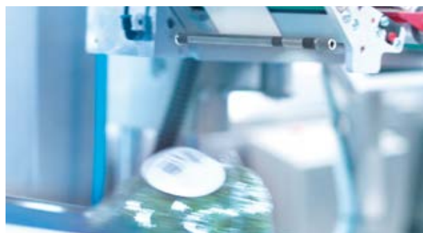
Bei Gebr. Hoff en Zonen werden an Förderlinien pro Minute bis zu 140 Brokkoli vollautomatisch in Folie eingeschweißt, gewogen, etikettiert und sortiert.
