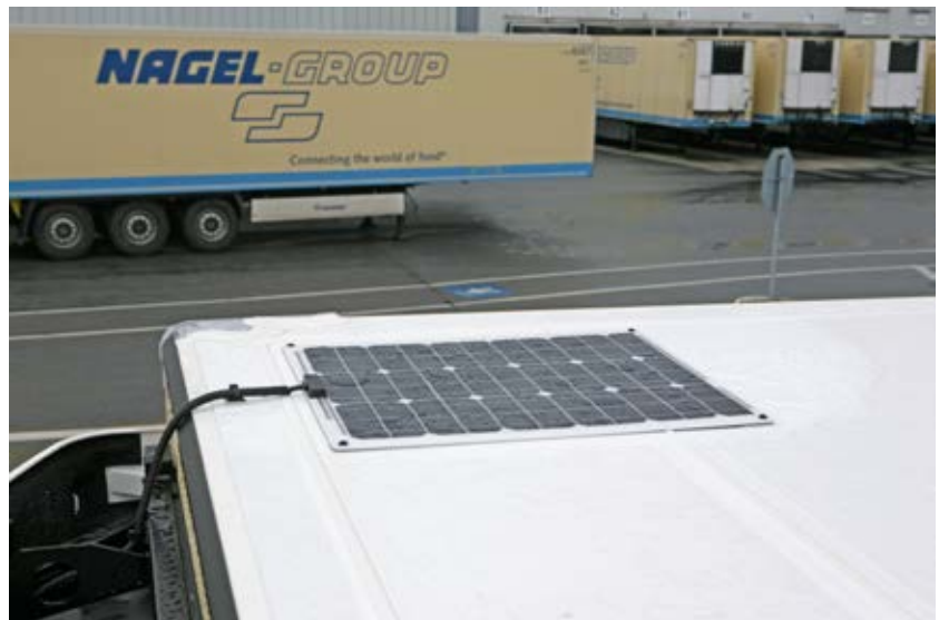
Solarpanel auf einem Kühlaufleger von Nagel.
