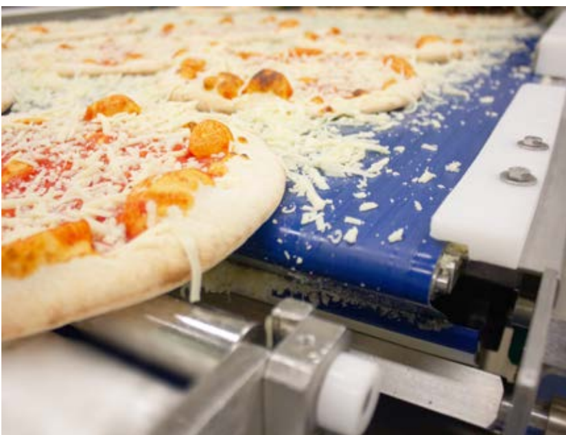
Der neue Habasit-Bandabstreifer aus thermoplastischem Polyurethan (TPU) im Einsatz.
