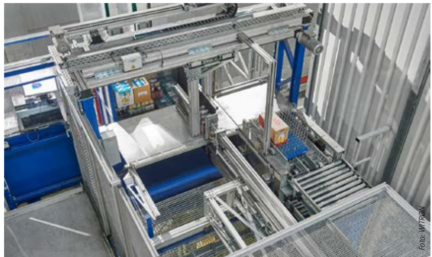
Ein zentrales Element im Rewe-Verteilzentrum Henstedt-Ulzburg ist die neueste Generation des Witron-OPM-Systems.
