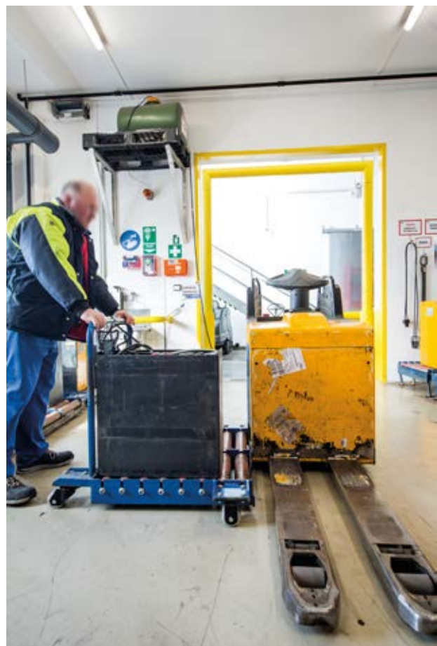
Der Wechsel der Batterien dauert oft nur wenige Minuten. Dann ist der Stapler wieder einsatzbereit.
