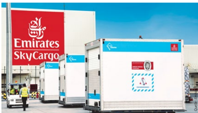
Neben der kurzen Distanz zwischen Flugzeug und Frachtterminal sollen »Cool Dollys« helfen, die Kühlkette für den wertvollen Impfstoff aufrechtzuerhalten.
