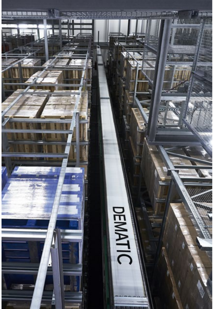
Das neu vollautomatisiertes Hochregallager in Wielsbeke verfügt über acht Regalbediengeräte.
