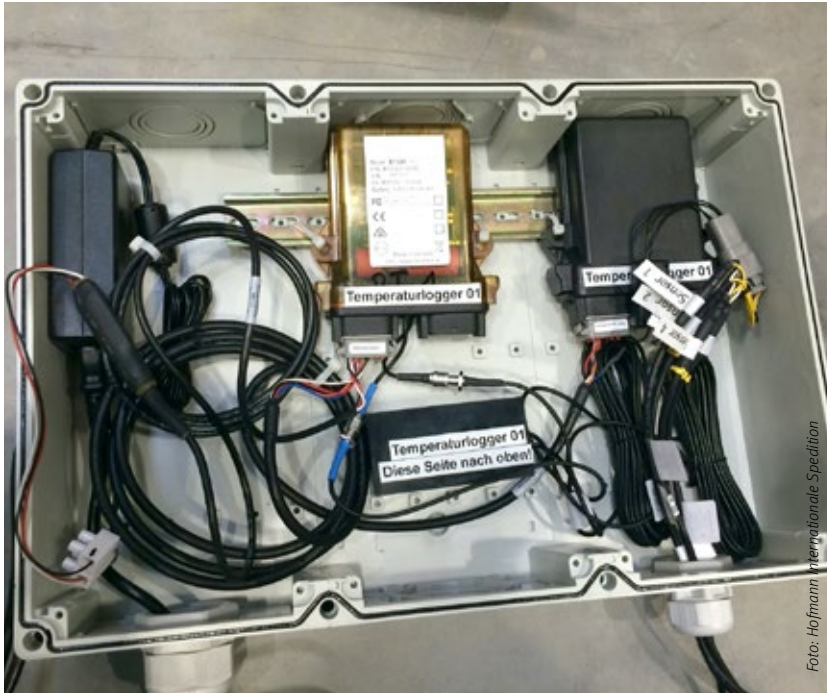
Die Orbcomm-Einheit BT 320 – verbaut in der Steuerbox.
