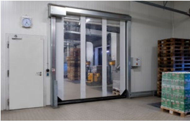
Das EFA-SRT mit Soft Touch System, ausgestattet mit einem Torblatt mit flexiblem Bodenabschlußprofil und Ausklinkmechanismus zur Vermeidung von größeren Schäden an Personen, Fahrzeugen und Ladegut bei Kollisionen.
