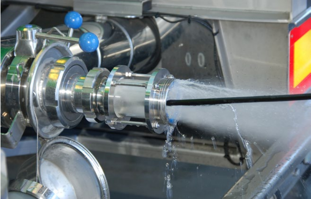
Die Hochdruck-Reinigungsdüse für schlecht zugängliche Bereiche am Tankwagen arbeitet mit bis zu 175 bar Druck und 80°C.
