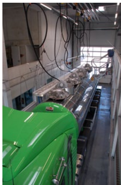
Der Tankwagen ist komplett mit Sprühlanzen-Einsätzen verschlossen, wenn die Hochdruckreinigung startet.
