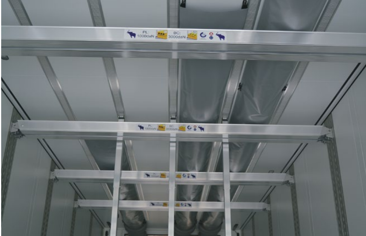
Das neue Luftverteilungssystem des S.KO Cool Smart gewährleistet auch eine zuverlässige und effiziente Ladungssicherung.
