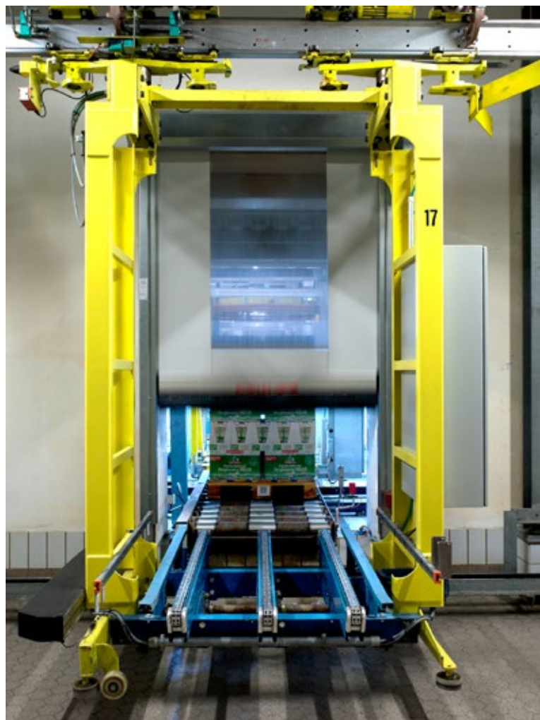
Das EFA-SRT-MS ist ein Maschinenschutztor, das für den Einsatz als »bewegliche trennende Schutzeinrichtung« gemäß Maschinenrichtlinie 2006/42/EG geeignet ist.
