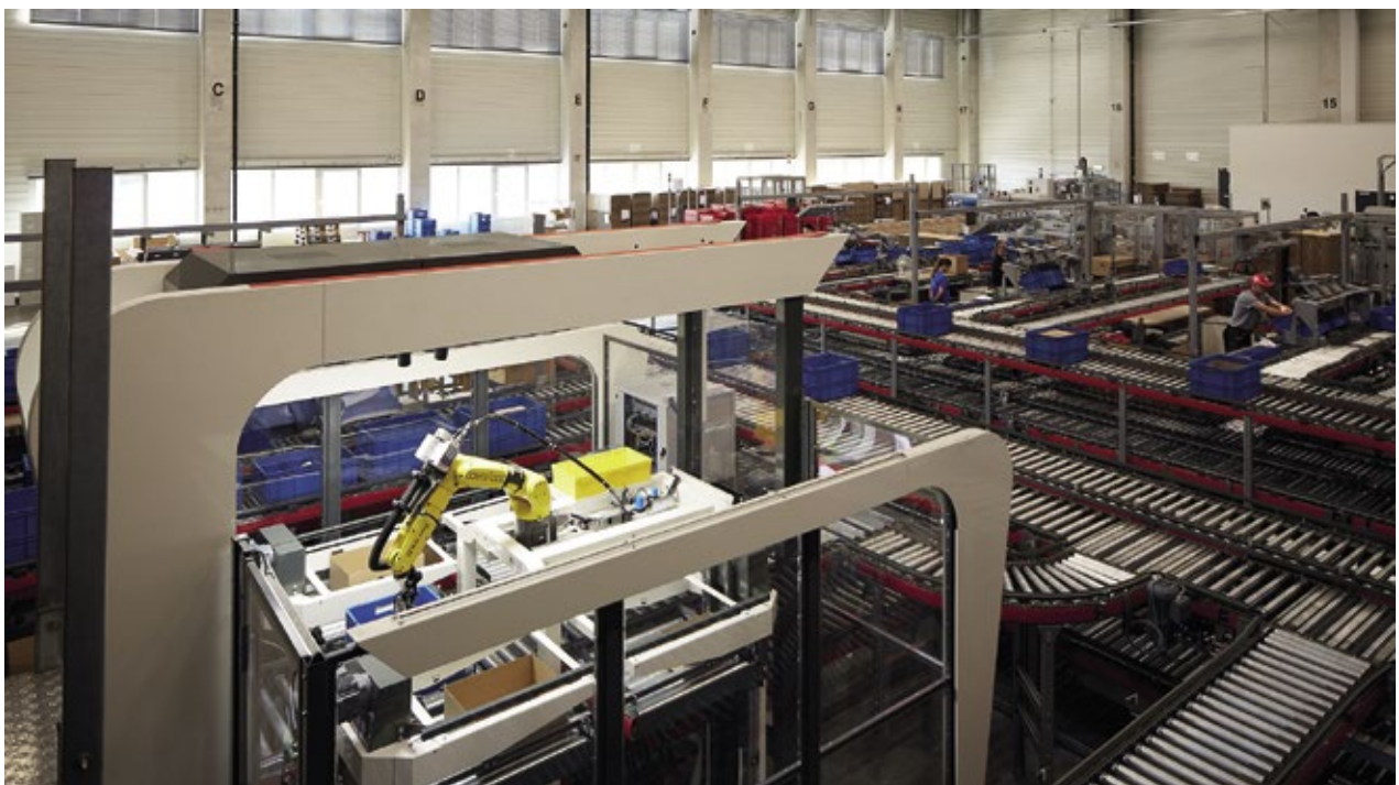
Der Kommissionierroboter Pick-it-Easy Robot unterstützt bei der Auftragsbearbeitung im Lager.
