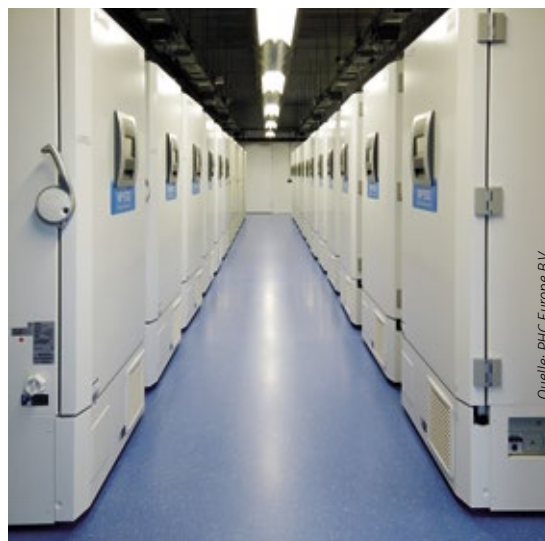
So sehen die Ultra-Tiefkühlschränke von Panasonic Healthcare aus, die auch für die Lagerung von Corona-Impfstoffen bei -80^{\circ}\text{C} geeignet sind.
