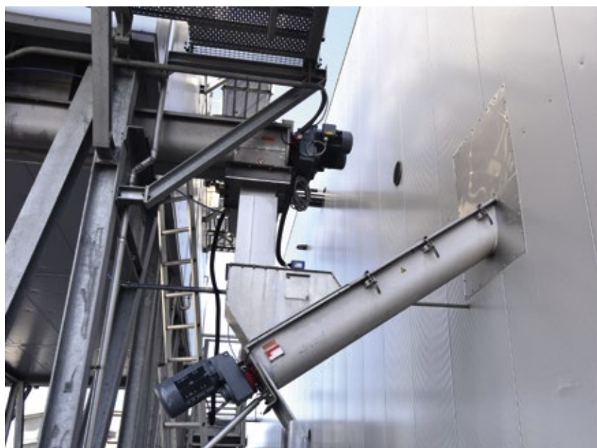
Das Eis muss von der Produktion zu den Dosern bedarfsgerecht gefördert werden, ohne zu verklumpen.
