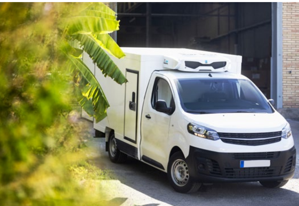
Bei Zanottis Produktreihe »Zero« kann die Verflüssigereinheit auf dem Dach oder an der Stirnwand des Kastens montiert werden.
