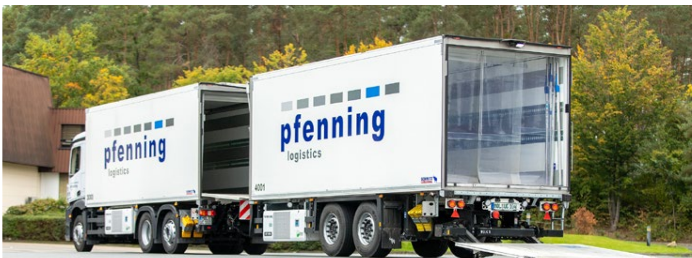
Der Tiefkühlgliederzug M.KO/Z.KO kann als Durchladezug genutzt werden.
