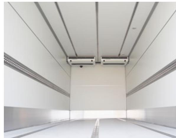
*Versenkte Schienen im FIP Aufbau.*
