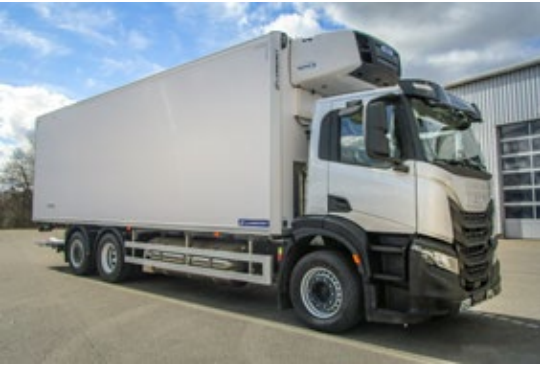
Das Messefahrzeug mit Lamberets Kühlkofferaufbau Frigoline HD basiert auf einem Iveco S-Way mit Gasantrieb und ist mit einer unterfaltbaren Ladebordwand von Dautel ausgestattet.
