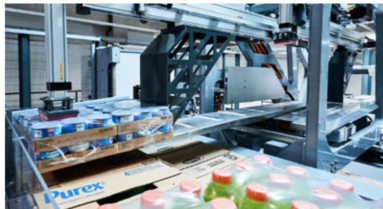
Der Robotic Universal Picker – kurz Runpick – kommissioniert und palettiert die Lebensmittel vollautomatisch.
