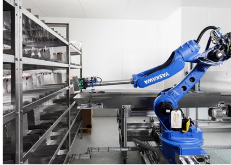
Herzstück der Anlage ist ein vielseitiger Handlingroboter Motoman GP25 von Yaskawa mit 25 Kilogramm Tragkraft.
