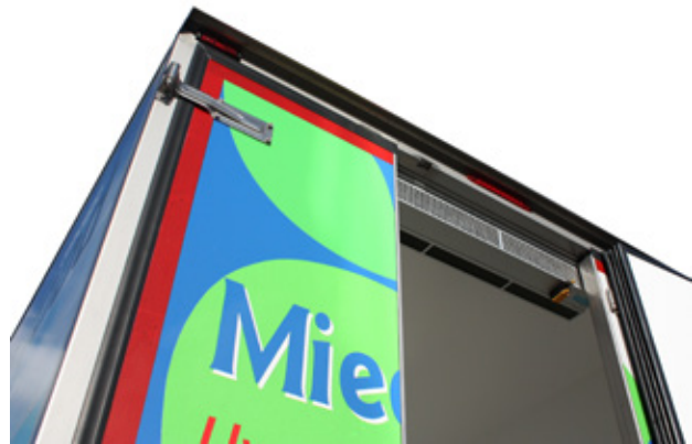
Kühlfahrzeug mit Blueseal Luftschleier über der Hecktür.
