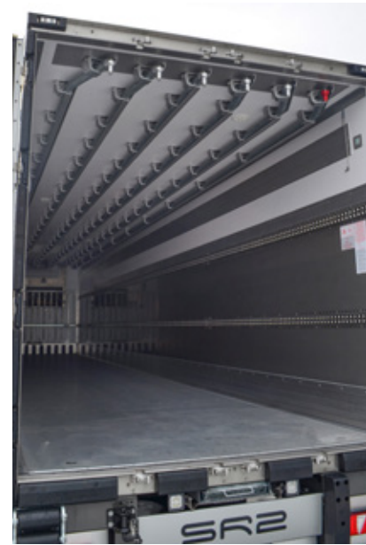
Die Aufleger sind mit Rohrbahnen für den Hängendfleischtransport ausgestattet.
