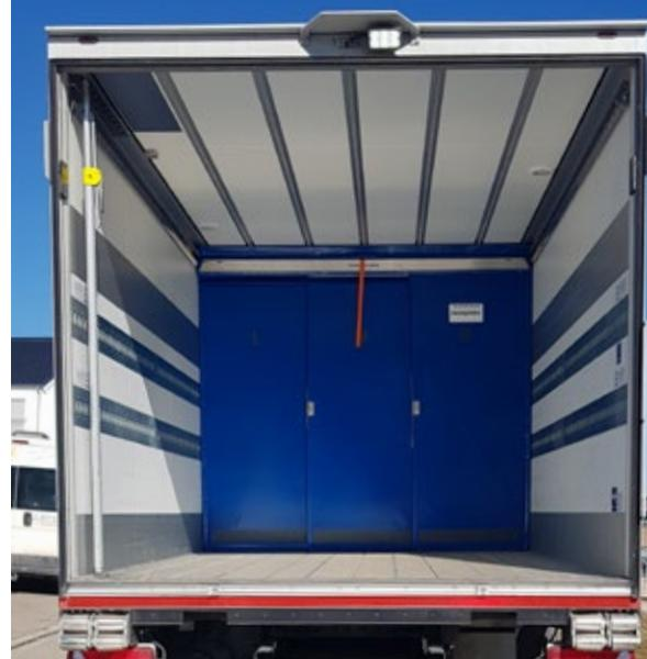
Der neue Segmentvorhang Iso.strong mit 60 Millimeter Spezialisierung.
