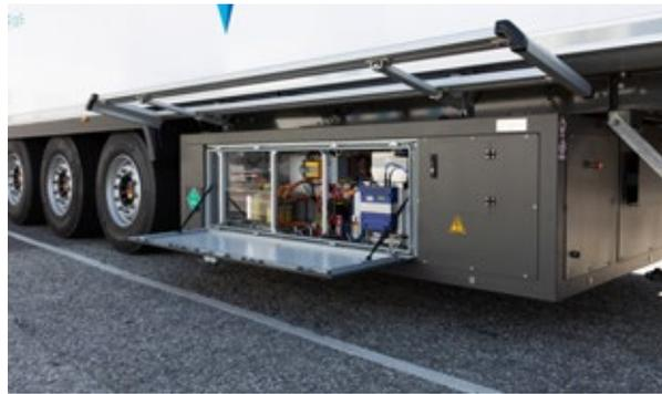
Die von Bosch entwickelte Brennstoffzelle am SR2 Fresh2 von Lamberet.
