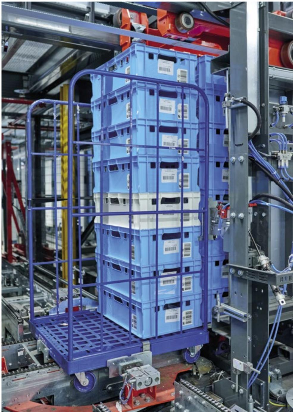
*Sechs Stapelmaschinen stellen shopspezifische Stapel zusammen, die automatisch auf das Ladehilfsmittel überschoben werden.*
