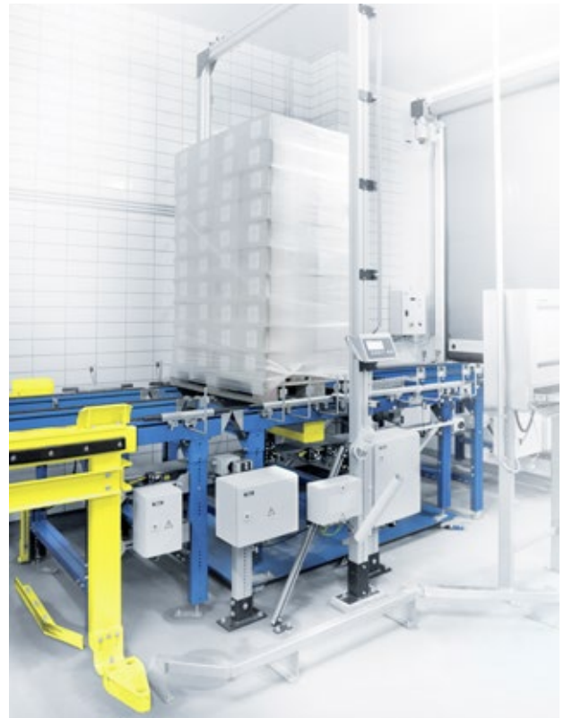
Vor der Einlagerung durchläuft die Palette einen Konturencheck sowie eine Gewichtsprüfung und wird gemäß den Ergebnissen von der Software Wamas dem optimalen Lagerplatz zugewiesen.
