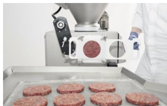
Mit dem Multiple Product Former MPF818 können Premium-Burger-Patties in unterschiedlichen Stärken und Durchmessern hergestellt werden.
