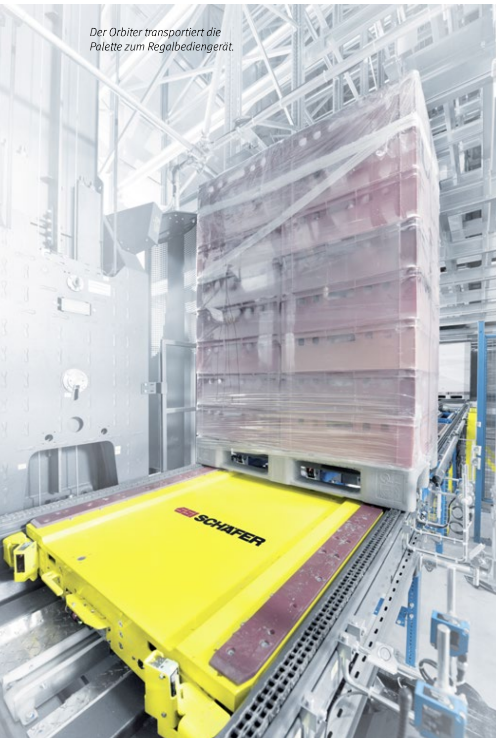
Der Orbiter transportiert die Palette sicher über die Regalschienen zum vorbestimmten Lagerplatz.
