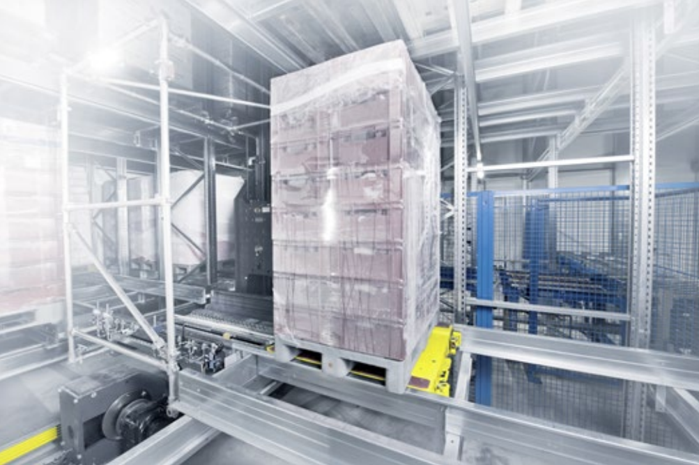
Der Orbiter transportiert die Palette sicher über die Regalschienen zum vorbestimmten Lagerplatz.
