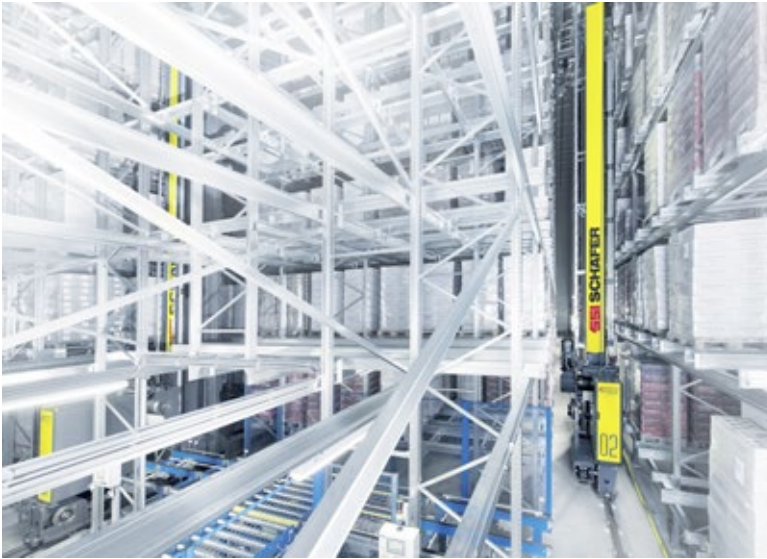
Regalbediengeräte Exyz von SSI Schäfer im Einsatz.
