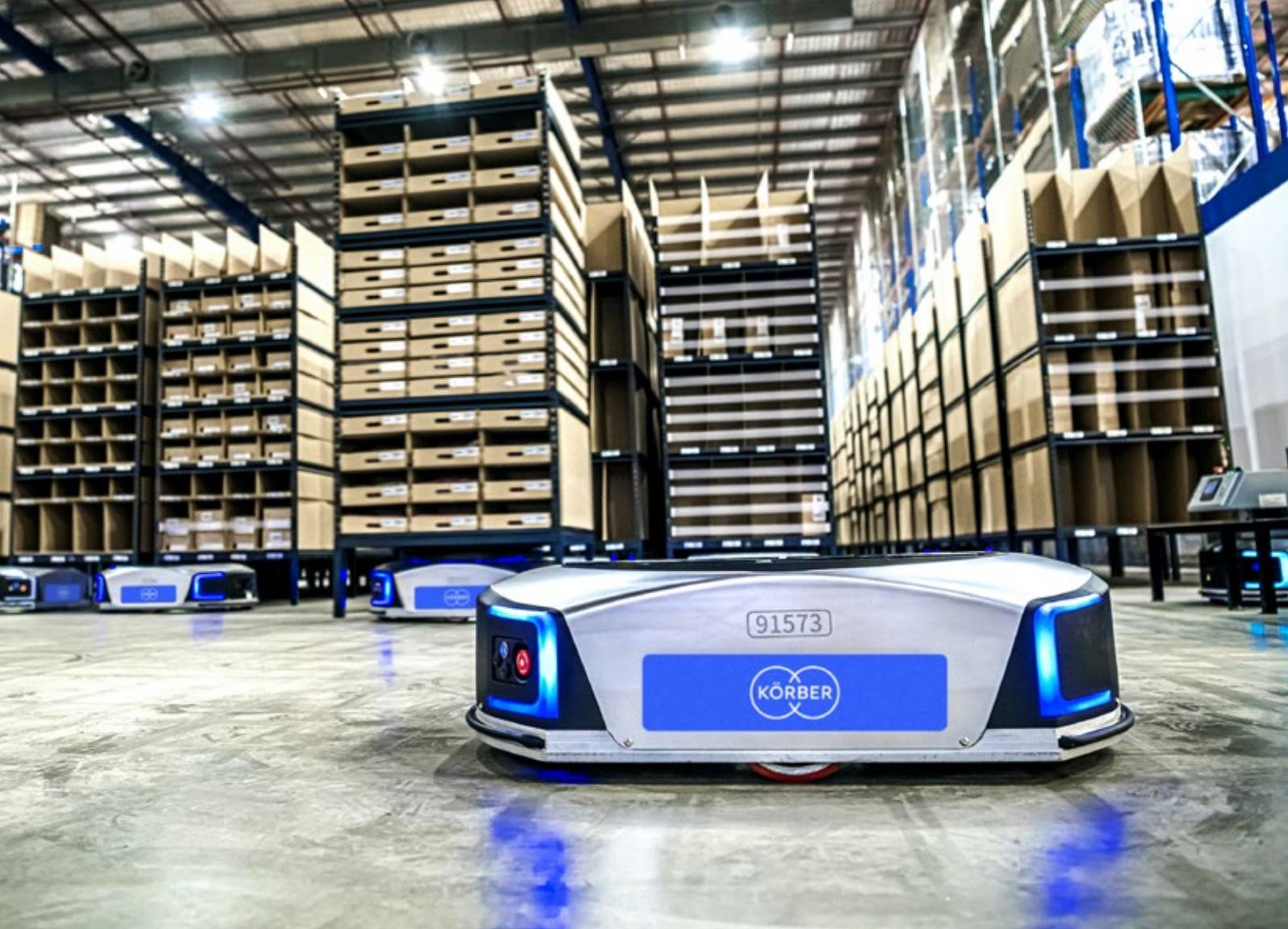
Autonome AMR sind durch den Verzicht auf Fahrschienen besonders flexibel und raumeffizient – in temperaturgeführten Bereichen ein relevanter Aspekt.
