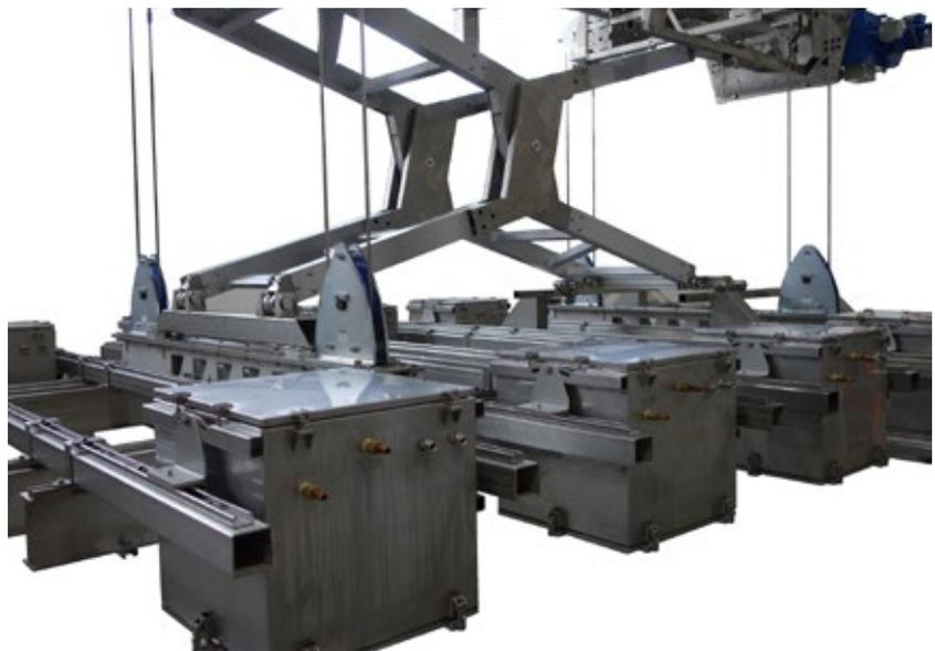
Die Elektroseilwinde Beta EL4 mit einer Traglast bis 1600 Kilo dient in der Sonnenlichtsimulationsanlage zum Heben und Senken der Rahmengestelle mitsamt den großen und schweren wassergekühlten Leuchten.
