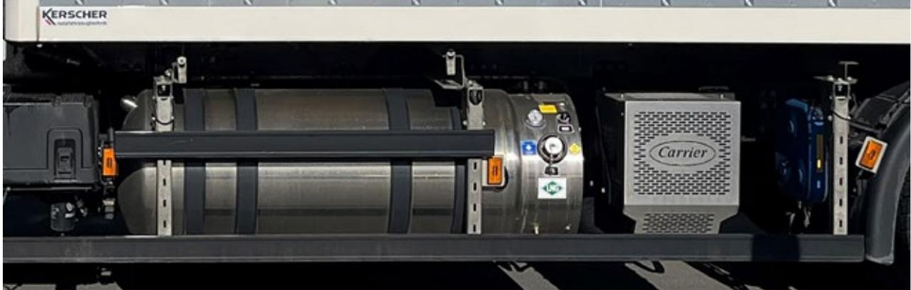
Trotz der großen LNG-Tanks bleibt ausreichend Bauraum für das kompakte Eco-Drive Generatormodul von Carrier Transicold.
