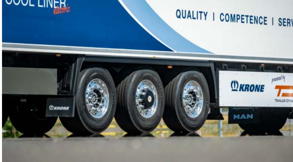
Das Kernstück der Krone eTrailer ist eine leistungsstarke eAchse, entwickelt zusammen mit dem Start-up Trailer Dynamics.
