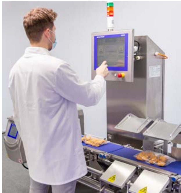
Kombisysteme vereinen verschiedene Produktinspektionstechnologien auf kleinstem Raum. Im Bild: Kontrollwägen und Metallfremdkörpererkennung mit dem Kombisystem CM33.
