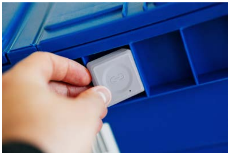
So sieht der Lora-Sensor »träck« aus.
