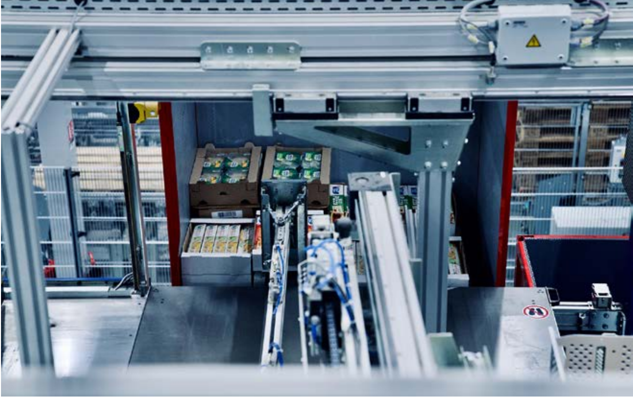
Vollautomatische Kommissionierung eines breiten Sortiments an Frische-Artikeln.
