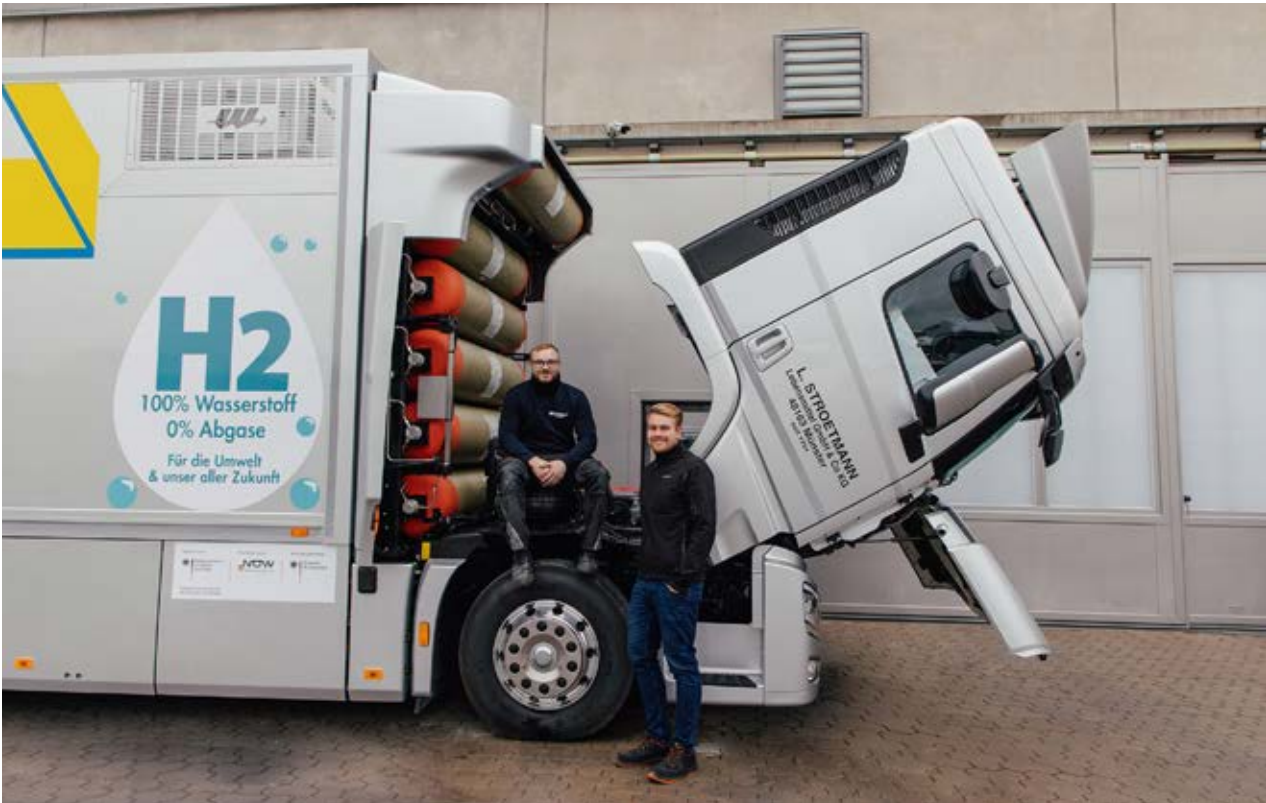
Robin Bennemann, wasserstoffgeschulter Wüllhorst-Mitarbeiter (links) und Projektbegleiter Felix Wüllhorst vor dem Hyundai Xcient Fuel Cell mit gekipptem Fahrerhaus: Die sieben Wasserstofftanks fassen ein Gesamttankvolumen von 31 Kilogramm Wasserstoff unter 350 bar.
