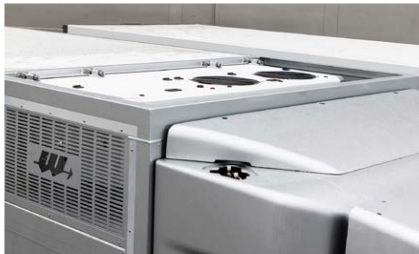
Die Kühlmaschine von Frigoblock hat Wüllhorst in eine Nische im Aufbau integriert.
