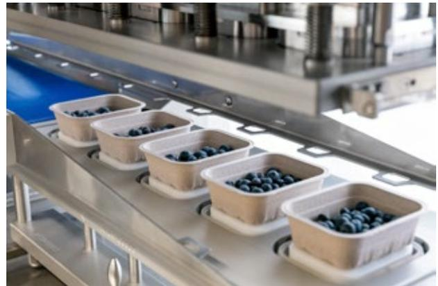
Die in Berlin ausgestellte Anlage um den Traysealer TX 710 verpackt frische Beeren in biologisch abbaubare Trays und versiegelt sie mit einer kompostierbaren Schutzfolie.
