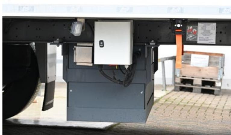
*Die TFV150-E wird über ein zusätzliches Batteriesystem angetrieben, die Batteriekapazitäten reichen laut Mitsubishi von 30 bis 100 kWh.*
