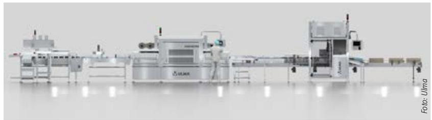
Highlight am Ulma-Stand ist die Hochleistungs-Schalenversiegelungsanlage mit automatischer Beladung und Verpackung
