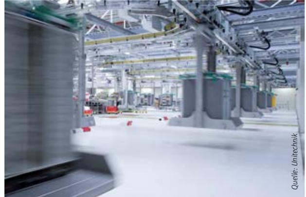
Eine 2,5 Kilometer lange Elektrohängebahn transportiert die Carts durch die weit verzweigte Anlage.
