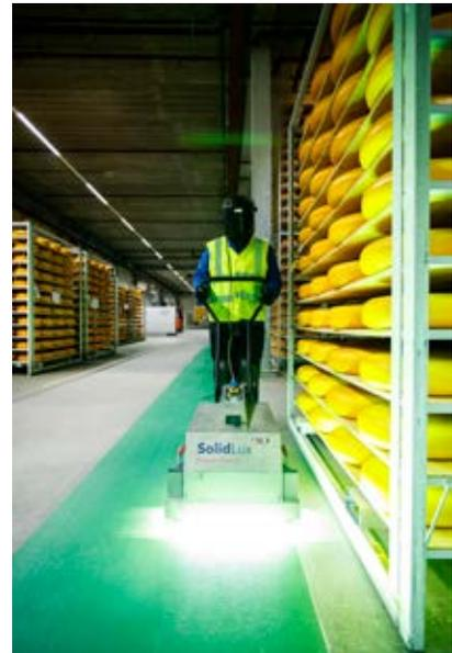
*Das verwendete Material härtet unter UV-Licht sofort aus, ohne die Umgebungstemperatur erhöhen zu müssen.*
