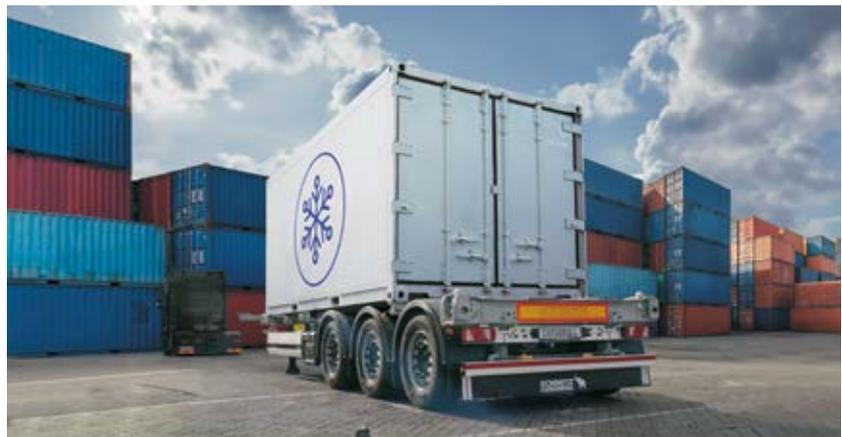
Das Sattelcontainerfahrgestell S.CF Allround ist flexibel für Container von 20 bis 45 Fuß mit Tunnel einsetzbar.
